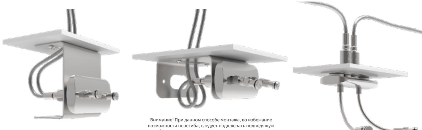
Внимание! При данном способе монтажа, во избежание возможности перегиба, следует подключать подводящую трубку, скрутив ее в кольцо, как показано на рисунке.
