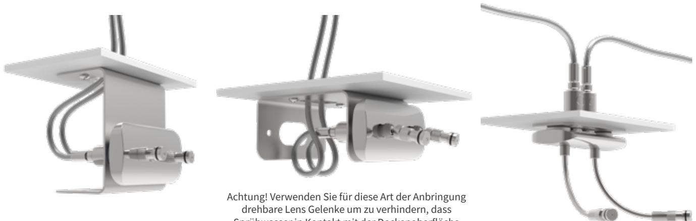
**Achtung!** Verwenden Sie für diese Art der Anbringung drehbare Lens Gelenke um zu verhindern, dass Sprühwasser in Kontakt mit der Deckenoberfläche kommt. Schließen Sie zusätzlich den Schlauch kreisförmig zusammengerollt an, um eine Überdehnung zu vermeiden.
